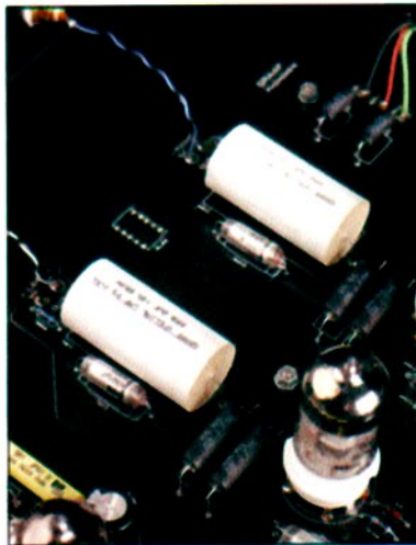
Die beiden großen Ausgangskoppelkondensatoren sind Sonderanfertigungen für das Gerät
