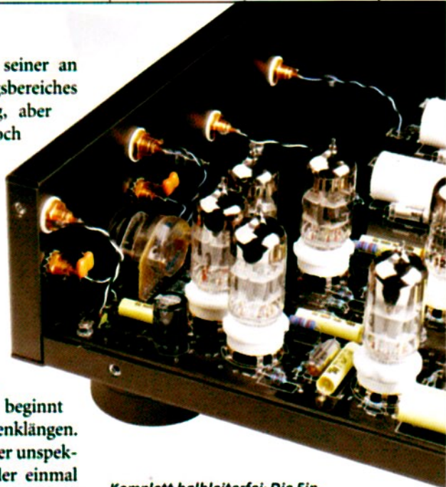
Komplett halbleiterfrei: Die Eingangsstufe schafft das Kunststück, auch mit Röhren MC-Signale auf ein standesgemäßes Niveau zu heben
