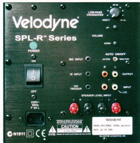
Volles Programm: Anschlüsse für alle gängigen Betriebsarten bietet der SPL 1200 R – inklusive Aktiv-Hochpass.
