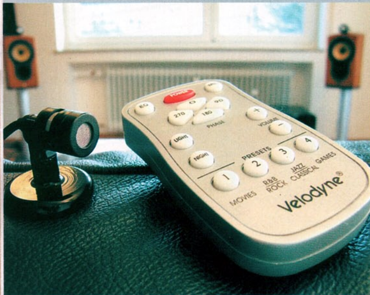
Kinderleicht: Den Button „EQ“ länger drücken, und schon beginnt das Einmessen. Das kleine Mikrophon sollte genau auf dem Hörplatz stehen – hier tut's die Sofalehne.
