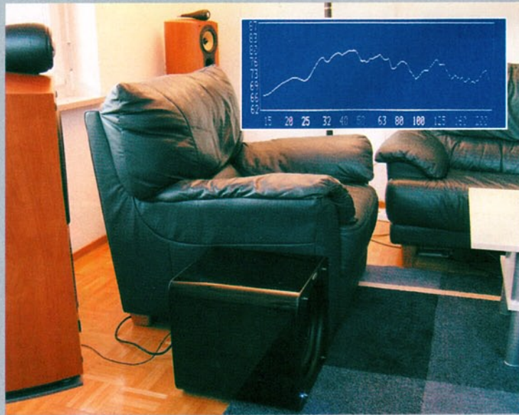
Endposition: Zwischen Front- und Rear-Speaker spielt der Sub im Projekt-Raum trockener, weil er die Raummode kaum noch anregt. Nach der Messung wurden Pegel und Phasenlage angepasst.
